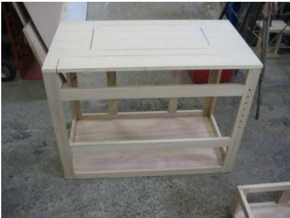
La parte superiore della cassa ove sarà collocato il somiere con le canne, la tastiera e la meccanica dei registri
