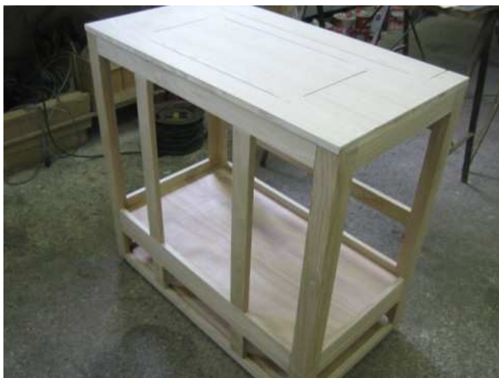
La cassa in castagno in costruzione
